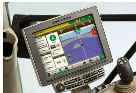
Les consoles 4600/4640 de 4e génération prennent en charge la commande de jusqu'à 255 sections d'équipement individuelles. Il vous offre une précision maximale et différentes possibilités de réduction des coûts.
